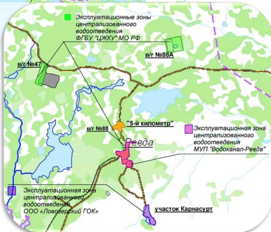
Рисунок 8. Карта-схема деления МО г.п. Ревда на эксплуатационные зоны водоотведения
