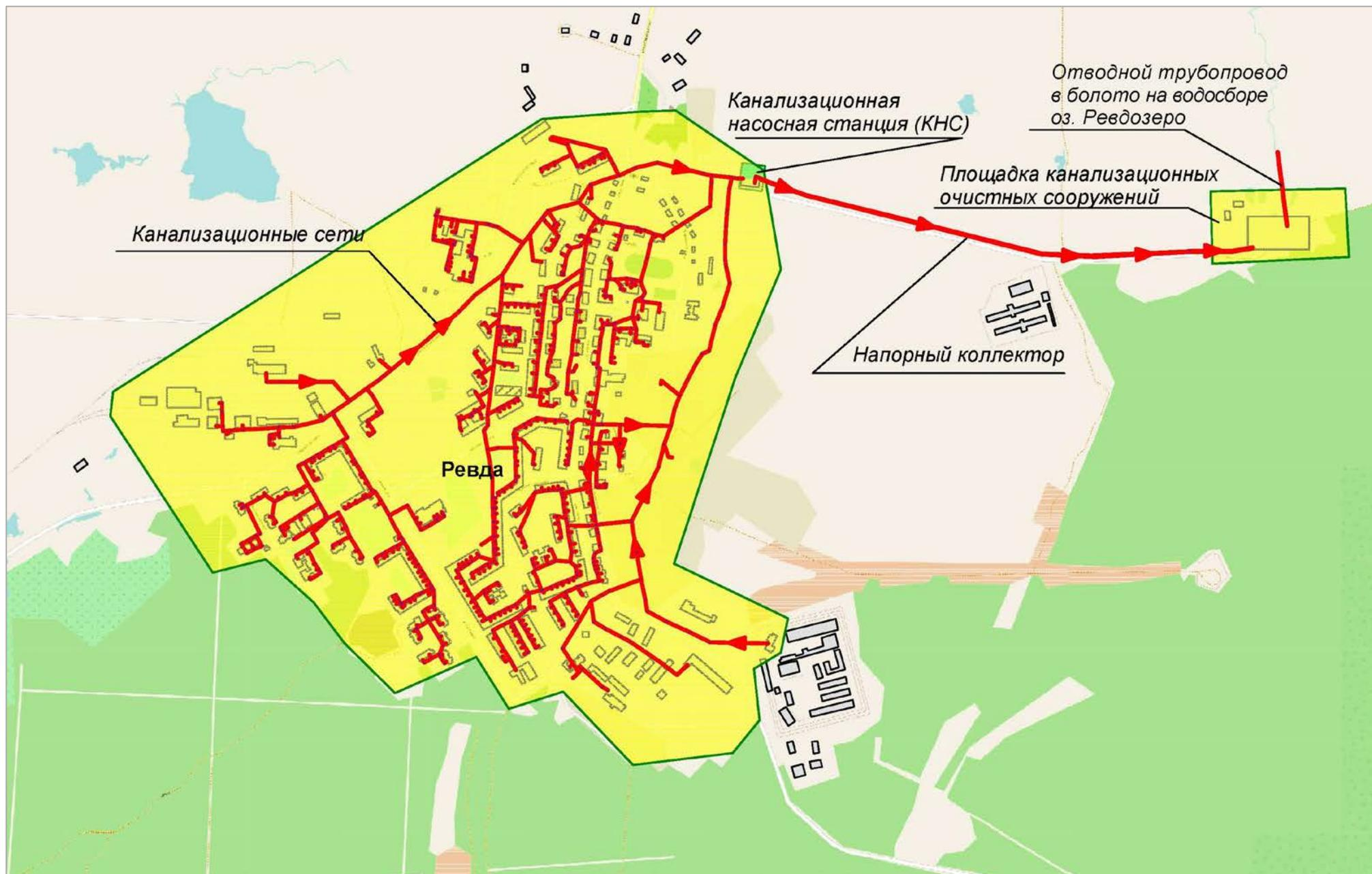
*Рисунок 9. Структура централизованной системы водоотведения пгт. Ревда*
