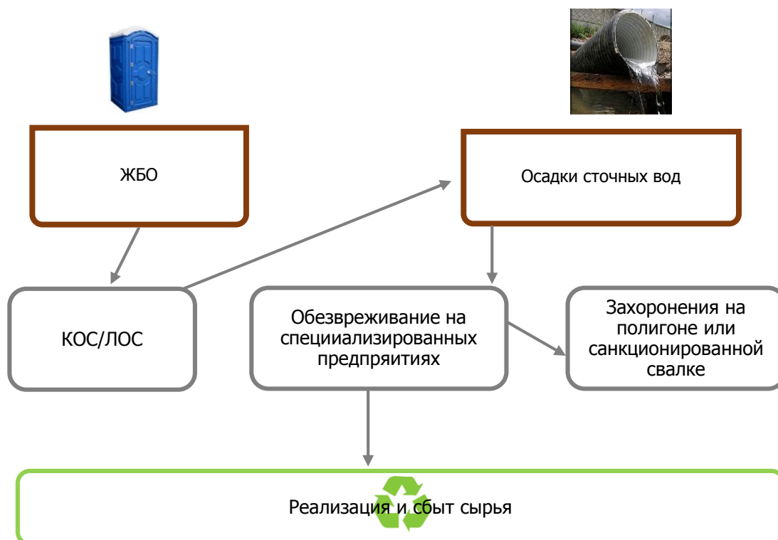
Рисунок 3.10 – Схема движения потоков ЖБО
