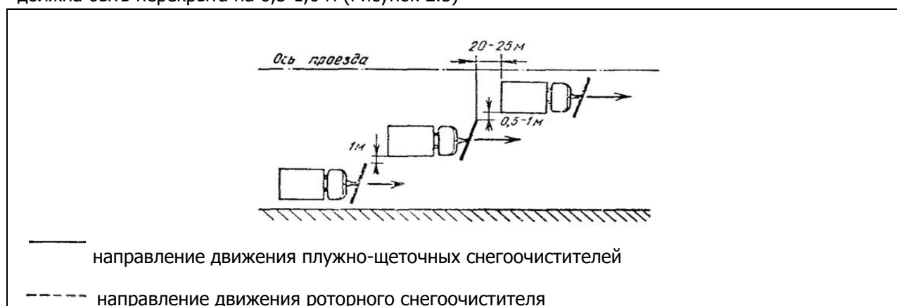
Рисунок 2.5. – Схема расчистки проезжей части улиц колонной плужно-щеточных снегоочистителей и складирование снега в лотке
